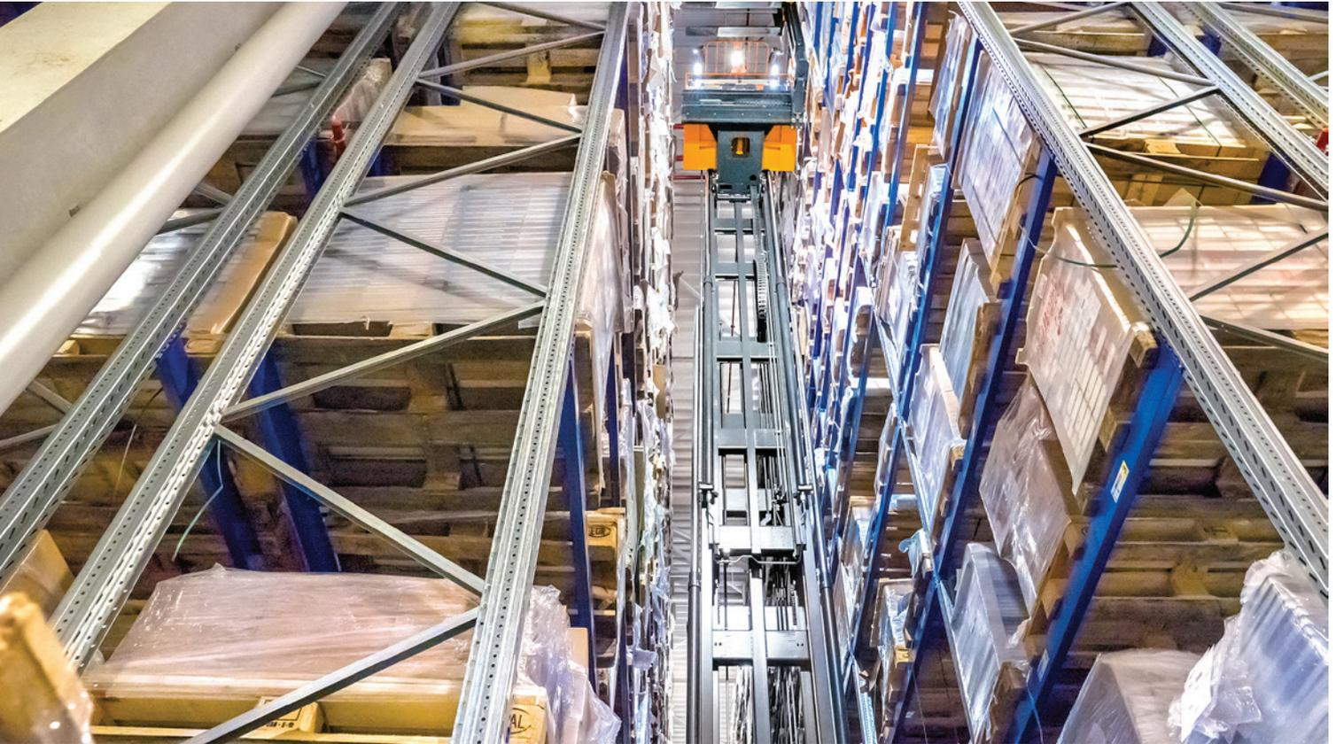
Bei Ein- und Auslagerungen werden mittels der On-Board-Steuerung von STILL die Schwingungen im Mast ausgeglichen und effektiv Zeit eingespart.
